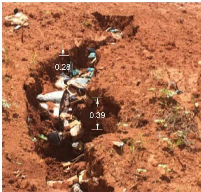
Foto 21: Medidas da espessura da cobertura atual do Aterro de Barra Longa.
