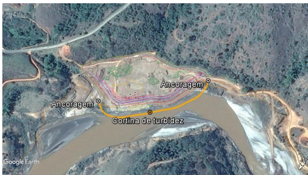
Figura 03 - Imagem esquemática da barreira de contenção de sedimentos
