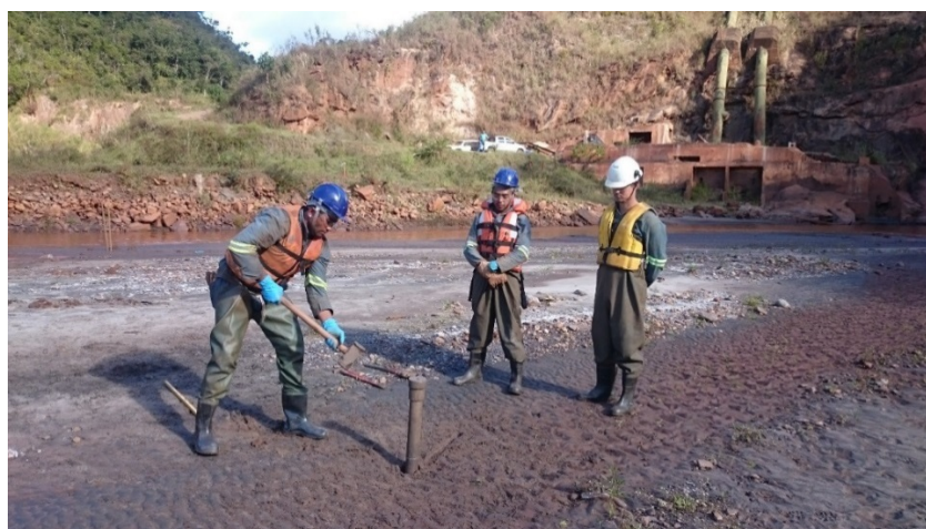
Foto 4: Atividade de sondagem nos bancos de rejeito (ilha).
