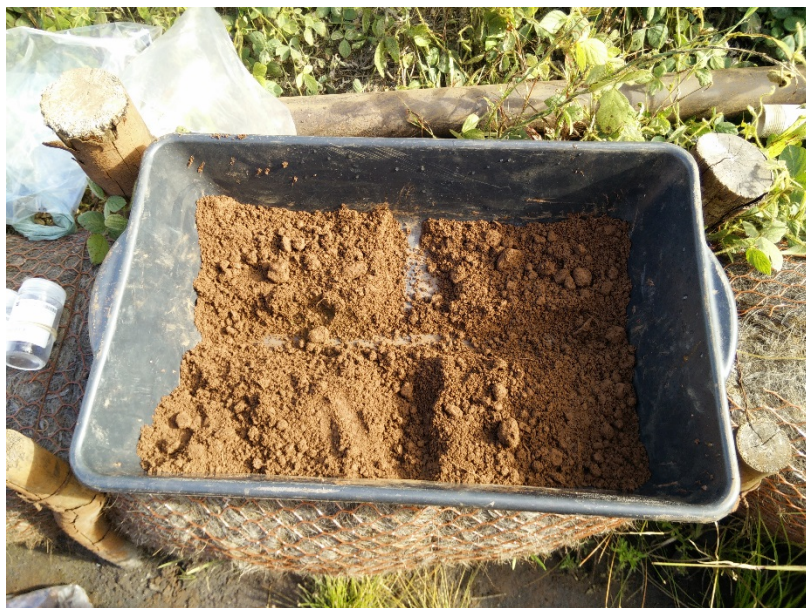
Foto 6: Homogeneização e quarteamento do rejeito coletado para coleta de amostra composta de metais.
