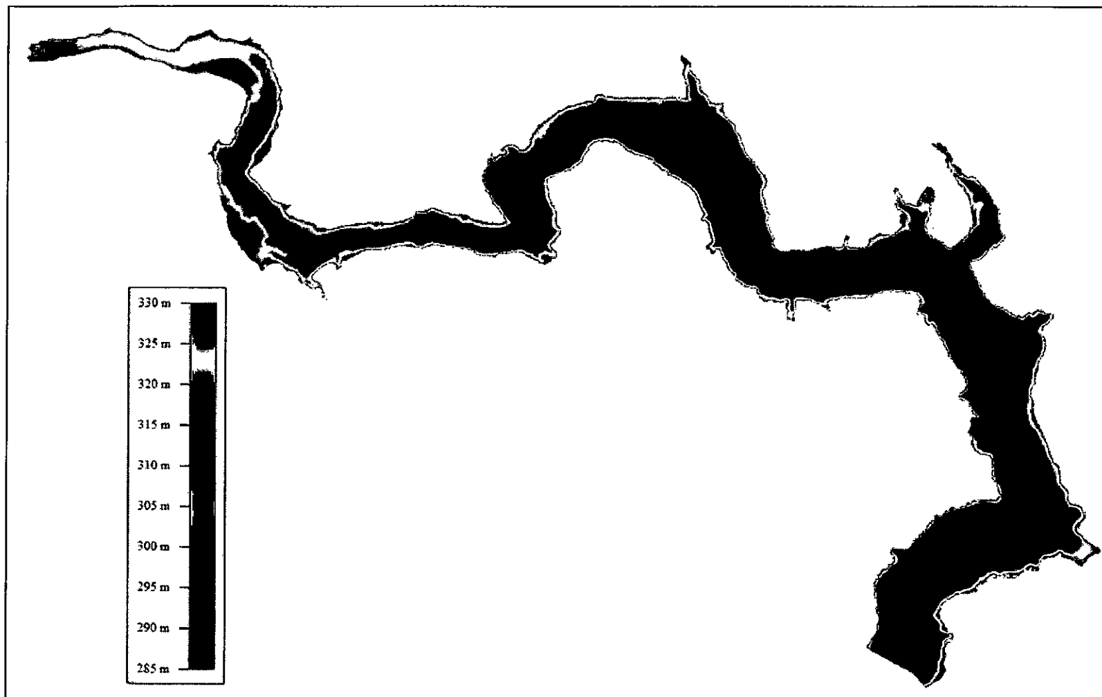
Figura 4. Estimativa em planta da calha do reservatório da UHE Risoleta Neves, em Março/2016
