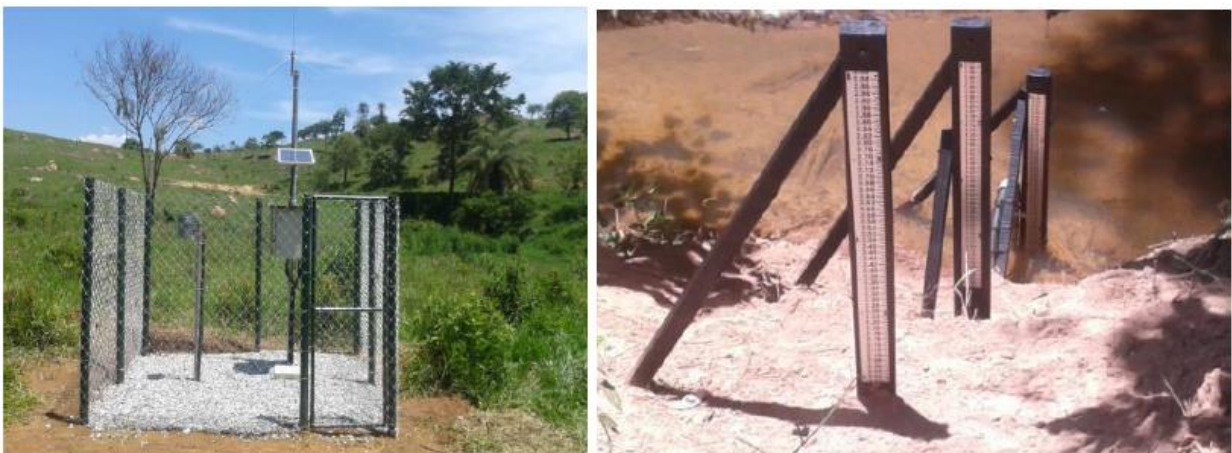
Figura 14: Características dos cercados (à esquerda) e modelo de régua limnimétrica (à direita)
