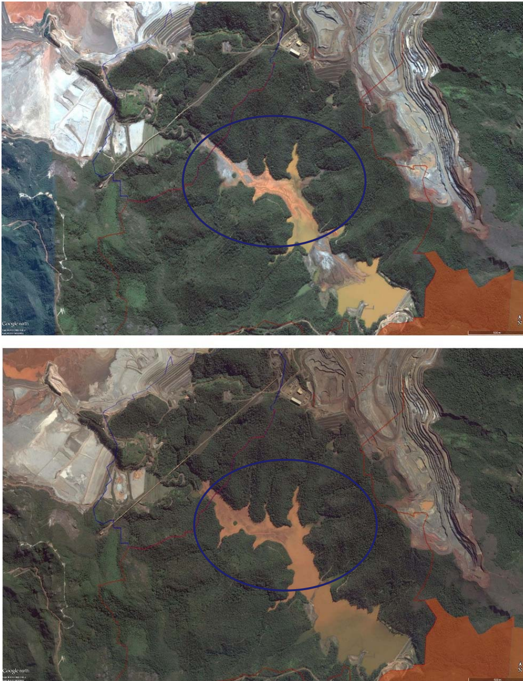
Figura 61 – Evidência da Existência de Rejeito Anteriormente ao Evento do Rompimento entre as Imagens de 10 de agosto de 2014 e 20 de julho de 2015 do Remanso da Barragem de Santarém.
