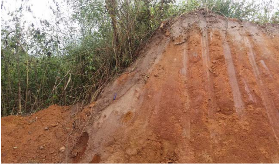
Foto 2a e 2b: Detalhe da camada de material detrítico (rejeitos), de coloração mais escura, com espessura aproximada de 0,5 m, acompanhando a topografia, classificado como Depósito Tipo II. Situado na aluvionar do rio Gualaxo do Norte, Trecho 6.
