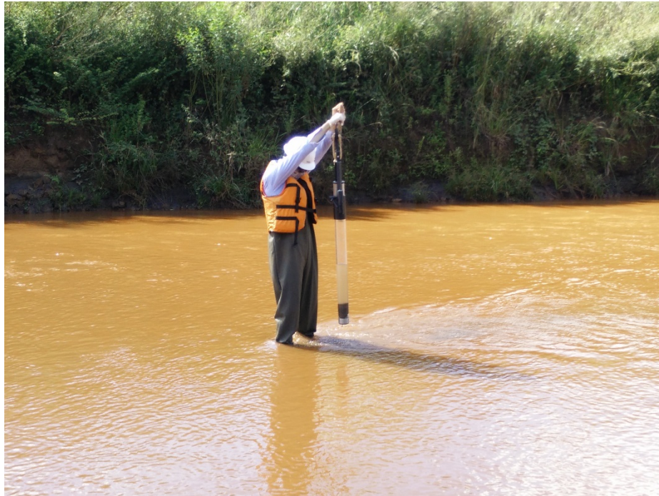
Foto 10: Detalhe do amostrador de sedimento tipo Kajak utilizado em campo
