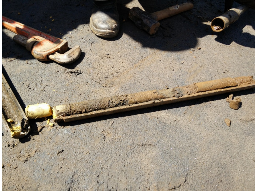
Foto 9: Detalhe do amostrador bipartido utilizado nas amostragens de campo
