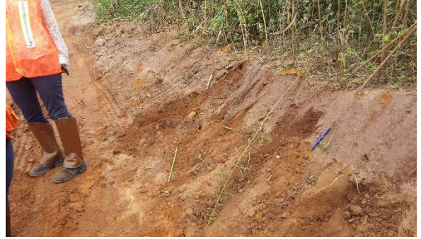
Foto 2a e 2b: Detalhe da camada de material detrítico (rejeitos), de coloração mais escura, com espessura aproximada de 0,5 m, acompanhando a topografia, classificado como Depósito Tipo II. Situado na aluvionar do rio Gualaxo do Norte, Trecho 6.
