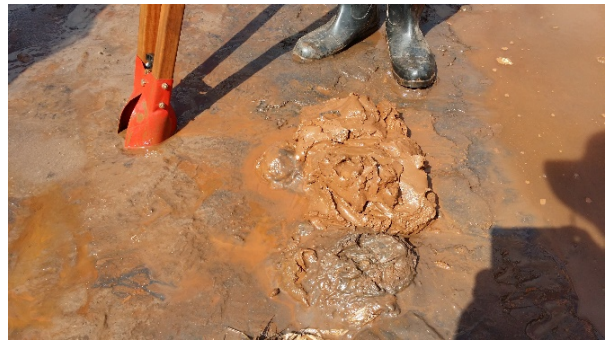
Fotos 8c e 8d: Depósitos Intracalha – Tipo III - na forma de praias, com sedimentos de constituição variando de areno-siltoargilosa a argilosa. Trecho 8.
