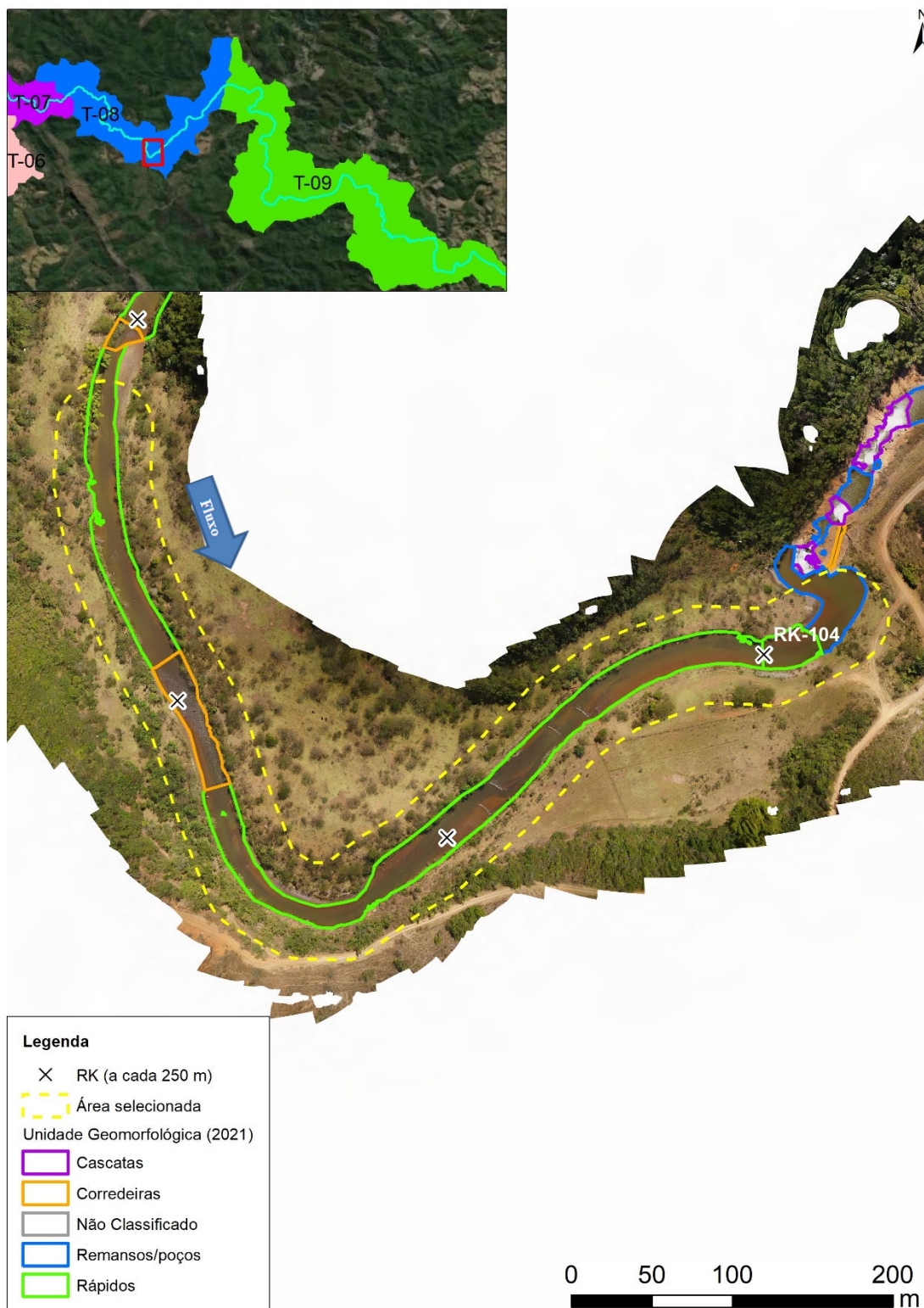
Figura 4. Área recomendada RGN-D junto ao RK-104, imagem da estação seca de 2021. Segmento predominantemente ocupado por habitats rápidos, intercalados com uma corredeira na região central, não possui vegetação ciliar de grande porte, e estradas permitem acesso ao local. A implantação de renaturalização é recomendado nos locais não ocupados por corredeiras, os quais estão destacados com linha pontilhada amarela.
