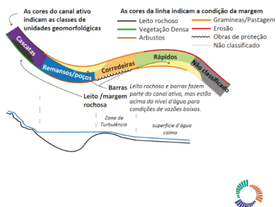
Figura 3: Modo de classificação dos "Habitats Físicos" utilizado na abordagem adotada pela Empresa NHC adaptado da literatura (BISSON et al., 2017, MONTGOMERY, D. R., & BUFFINGTON, 2007, 2008).
