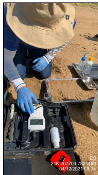
Foto 2. Medição de pH de amostra de sedimento com pHmetro Groline Hanna 98168.
