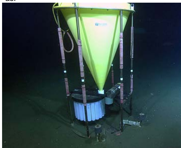
Figura 3 - Sistemas de amostragem sedimentar a serem empregados no projeto. Acima, armadilhas de sedimentos para integração sazonal; abaixo sistema de troca mensal automática.
