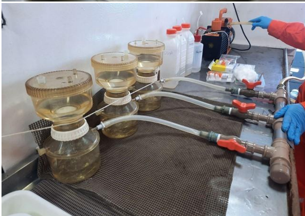
Figuras 7 e 8. Amostras e preparação do sistema de filtração à vácuo.
