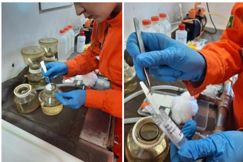
Figuras 10 e 11. Retirada do filtro e armazenamento do filtro das amostras filtradas.
