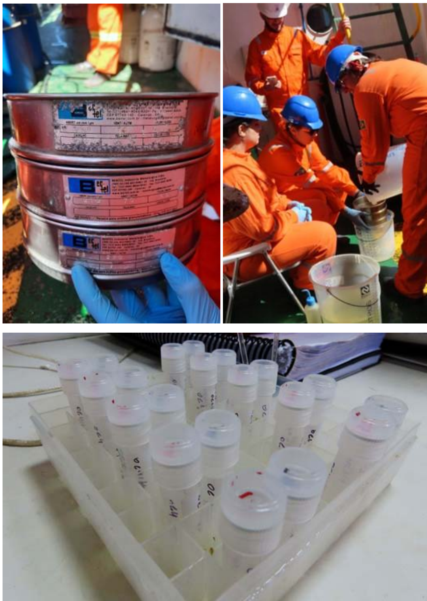
Figuras 25 a 27. Processo de separação de plâncton por filtragem em malhas progressivas (0,500mm, 0,212mm e 0,063mm)
