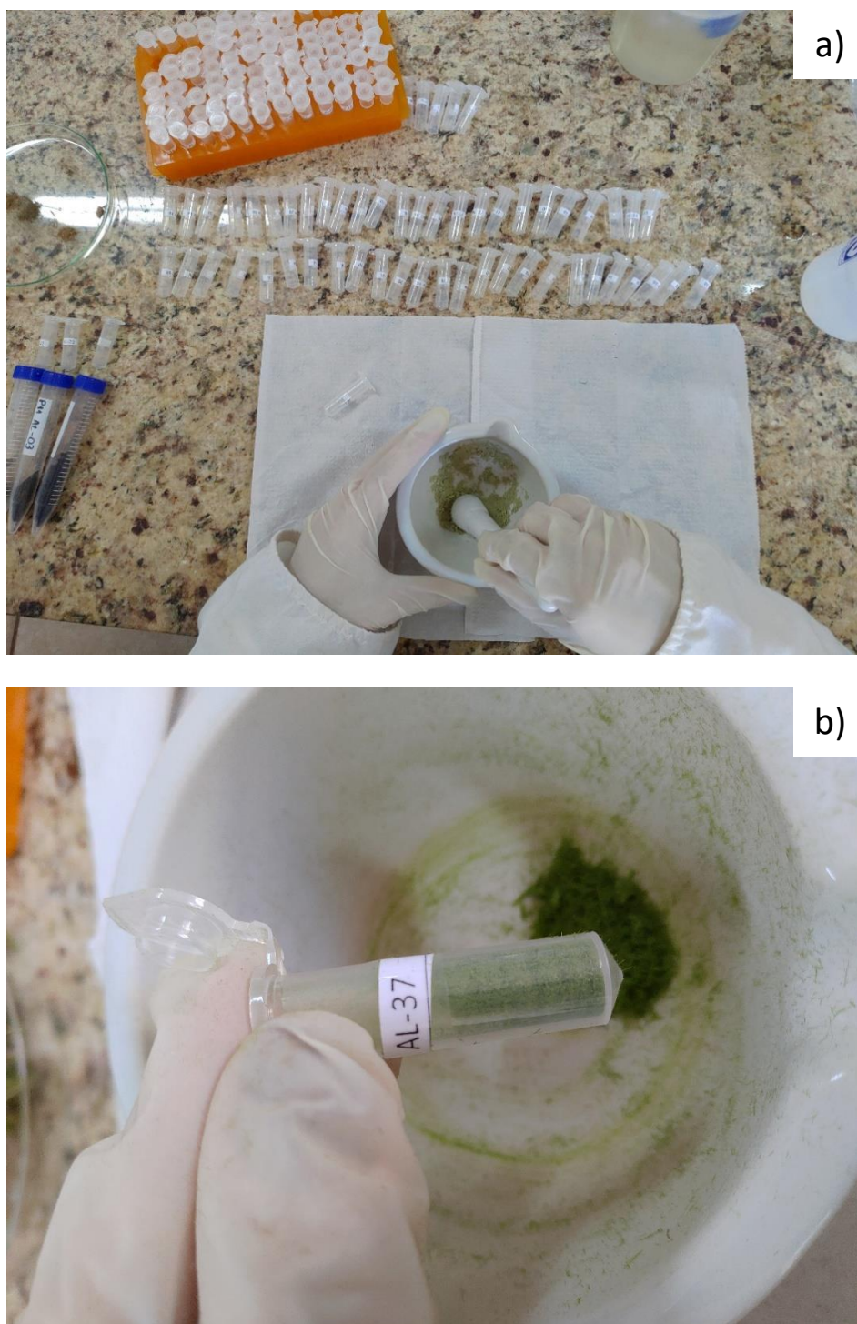
Figura 17 Processamento das amostras em laboratório: a) amostras sendo moídas a pó fino e homogêneo utilizando almofariz e pilão e b) amostra moída e pronta para ser encaminhada ao laboratório para análise isotópica
