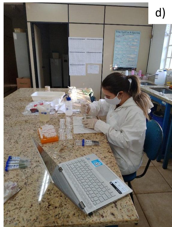
Figura 16 Processamento das amostras sólidas em laboratório: a) amostras sendo desidratadas no liofilizador; b) amostra ao final do processo de desidratação; c) amostra pronta para ser moída; d) amostras sendo moídas a pó fino e homogêneo utilizando almofariz e pilão.
