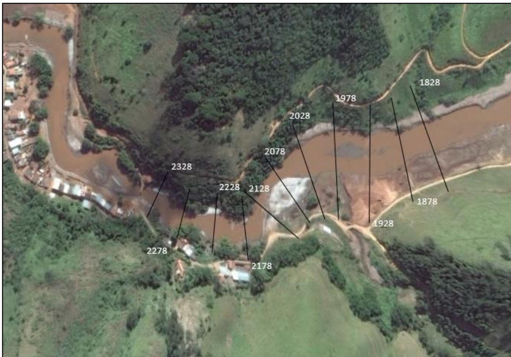
Figura 1: Layout do Modelo HEC-RAS (a montante da ponte de Barra Longa), (Figura A) e Layout do Modelo HEC-RAS (Barra Longa), (Figura B).
