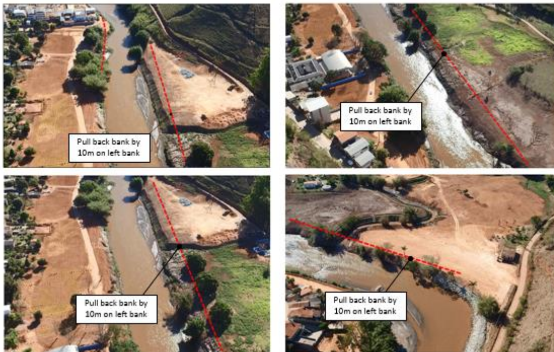
Figura 8: Mudanças na margem esquerda (Ch2800 a 2478).
