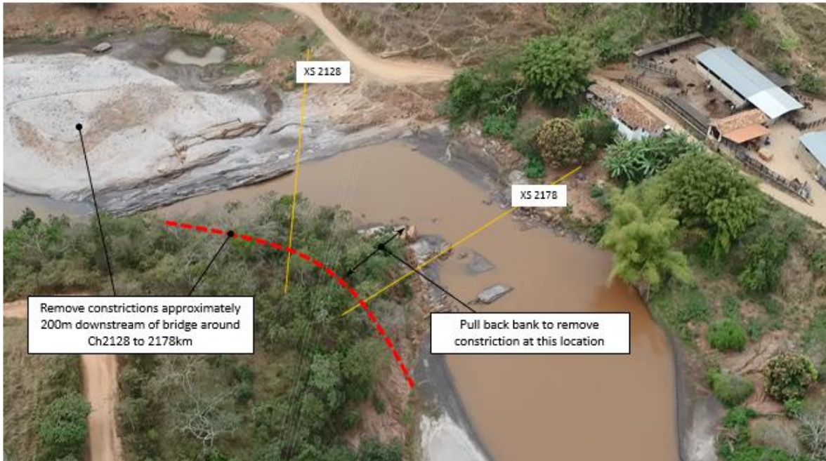
Figura 12: A Opção 2E inclui todas as modificações descritas na Opção 2A, mais a remoção de constrictões situadas dentro do canal, a jusante da ponte de Barra Longa
