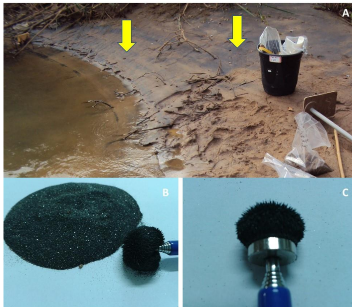
Figura 1. (A) Indicação da presença de mineral escuro-metálico no rio Doce, no ano de 2012; (B) Mineral escuro-metálico coletado em 2012 na foz do rio do Carmo; (C) Imã com mineral escuro-metálico indicando sua característica magnética. Fonte: Adaptado de Pacheco (2015) – Acervo do autor.
