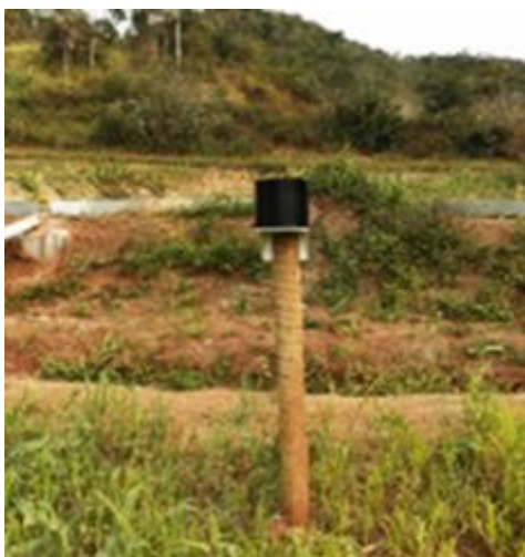
Figura 26: Data Logger das caçambas basculantes HOBO® Pendant® Event Data Logger (UA-003-64).
