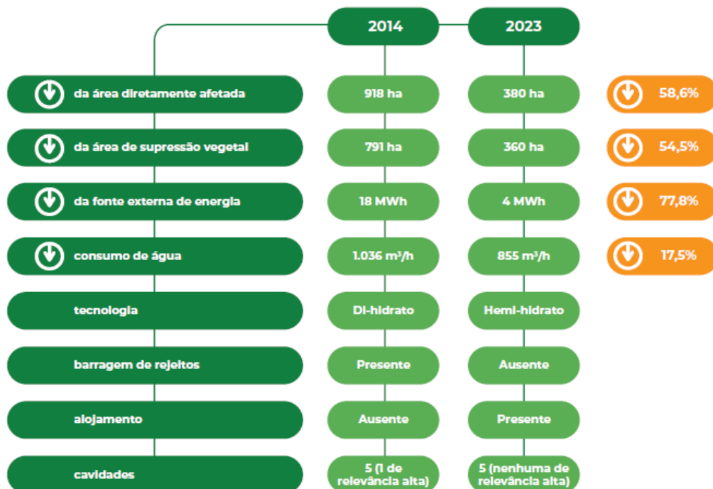
Figura 3: Quadro Comparativo entre Arranjos do Projeto
