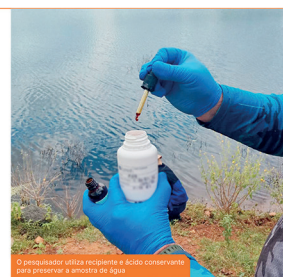
A pesquisadora coleta amostra de água subterrânea para posterior análise.
