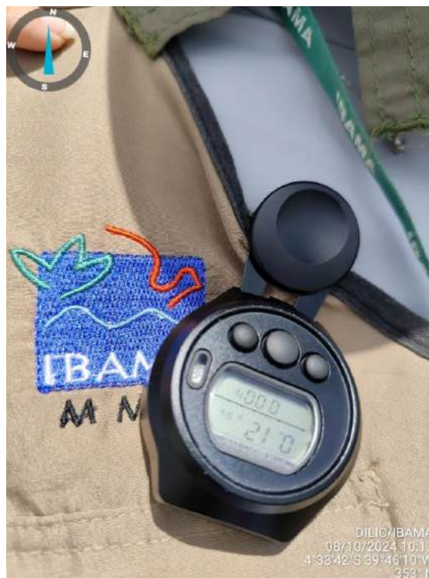
Foto 08 – Registro de dosímetro utilizado durante a vistoria na área da jazida.
