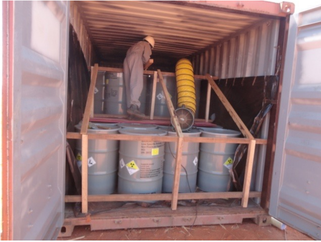
Tambores de armazenamento de concentrado de urânio nos contêineres imobilizados por intertravamento dos tambores.
