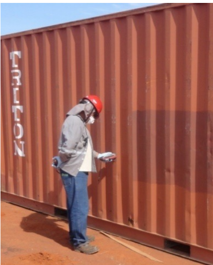
Monitoração dos níveis de radiação em diversos pontos do contêiner.
