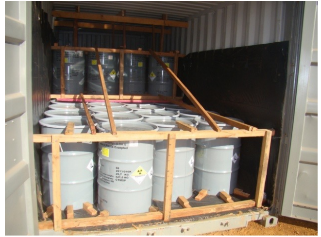
Tambores de armazenamento de concentrado de urânio nos contêineres imobilizados por intertravamento dos tambores.
