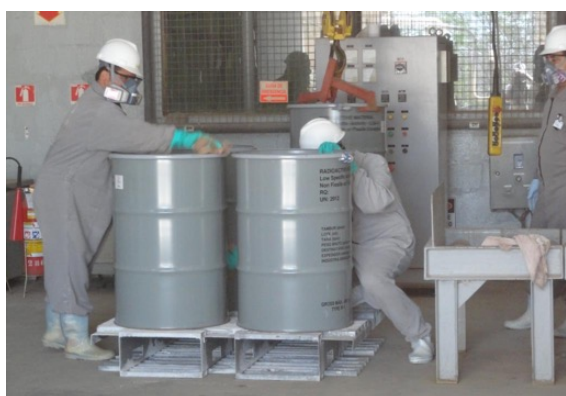
Avaliação e Limpeza dos tambores de armazenamento de concentrado de urânio.
