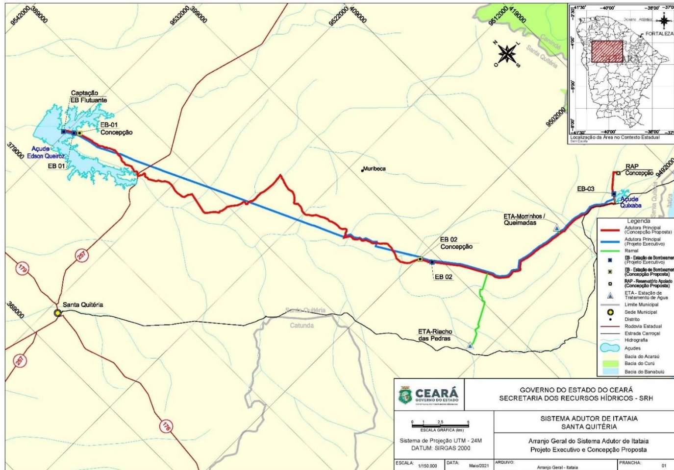
Figura 9.13-1: Arranjo Geral do Sistema Adutor Fonte: COGERH, 2021
