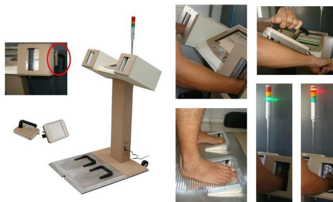
Figura 9.5-38: Monitor Fixo de Contaminação. Equipamento (à esquerda) e ilustração de sua utilização (à direita).
