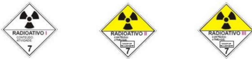
Figura 9.6-2: Sinalização para transporte de resíduos radioativos
