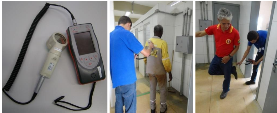
Figura 9.5-39: Monitor Portátil de Contaminação. Equipamento (à esquerda) e ilustração de sua utilização (ao centro e à direita).
