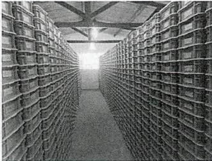
Fotografia 10: Caixas com testemunhos de sondagem no interior do Galpão 2.
