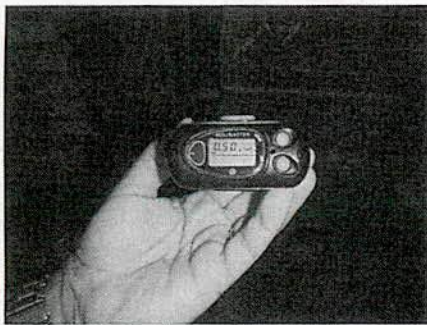
Fotografia 11: Dosímetro pessoal. Medição de dose no interior do Galpão 3.
