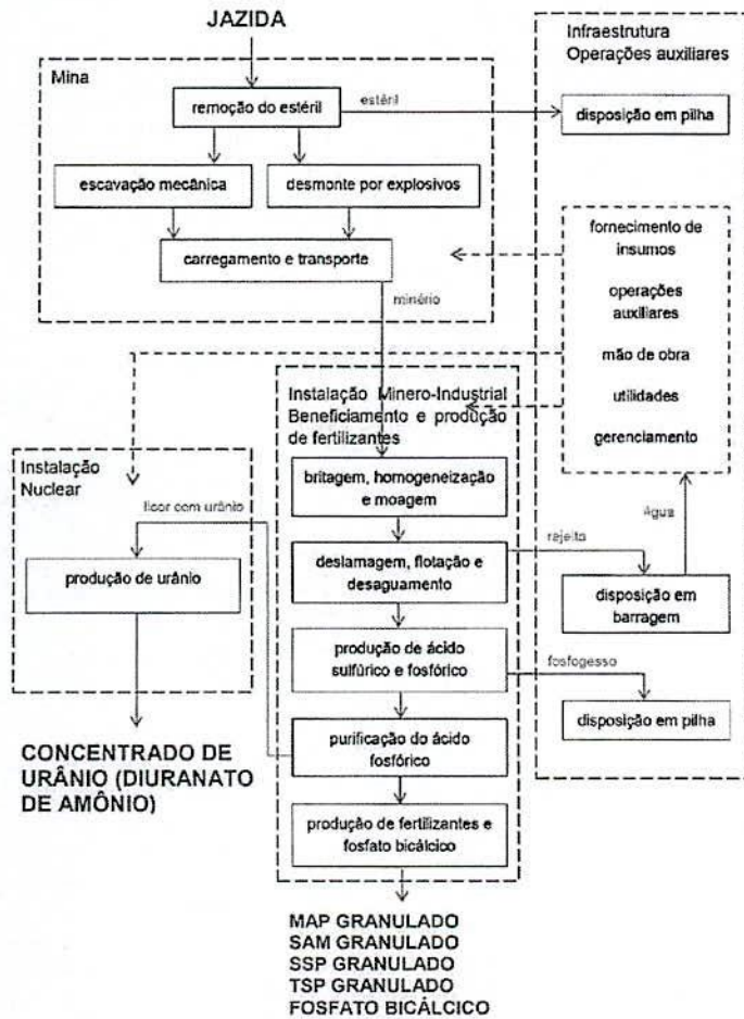
FIG. 1: Diagrama de blocos sintético geral das operações de produção a serem desenvolvidas no Projeto Santa Quitéria. Fonte: EIA, vol. 1, p. 132.
