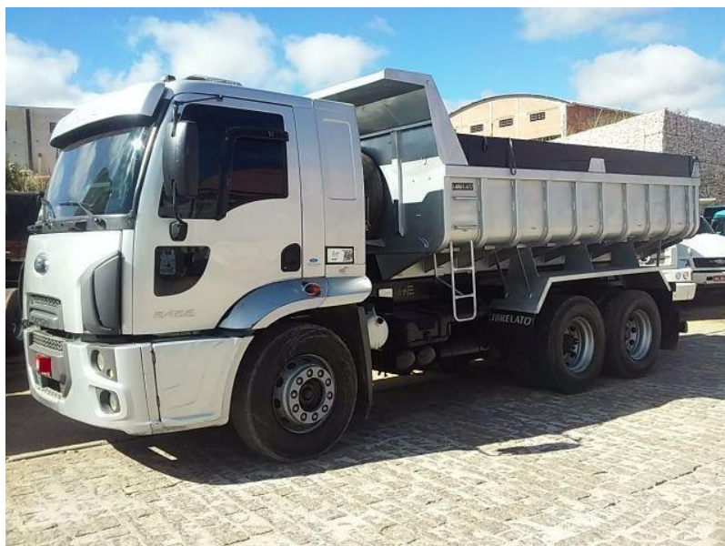
Foto 38 – Tipo de caminhão basculante utilizados em obras de terraplenagem
