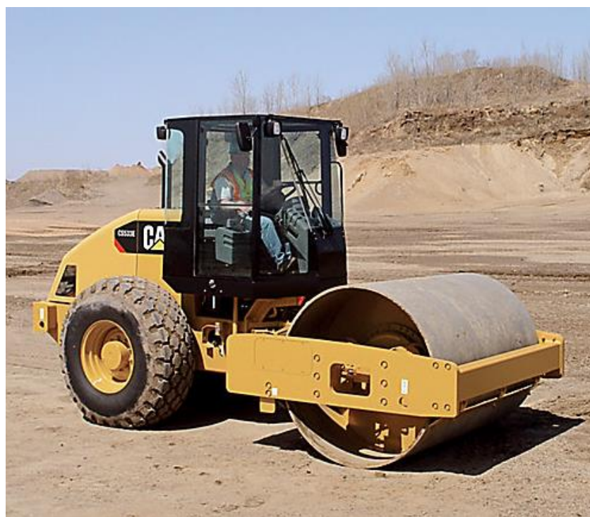
Foto 37 - Maquinário rolo vibrador
