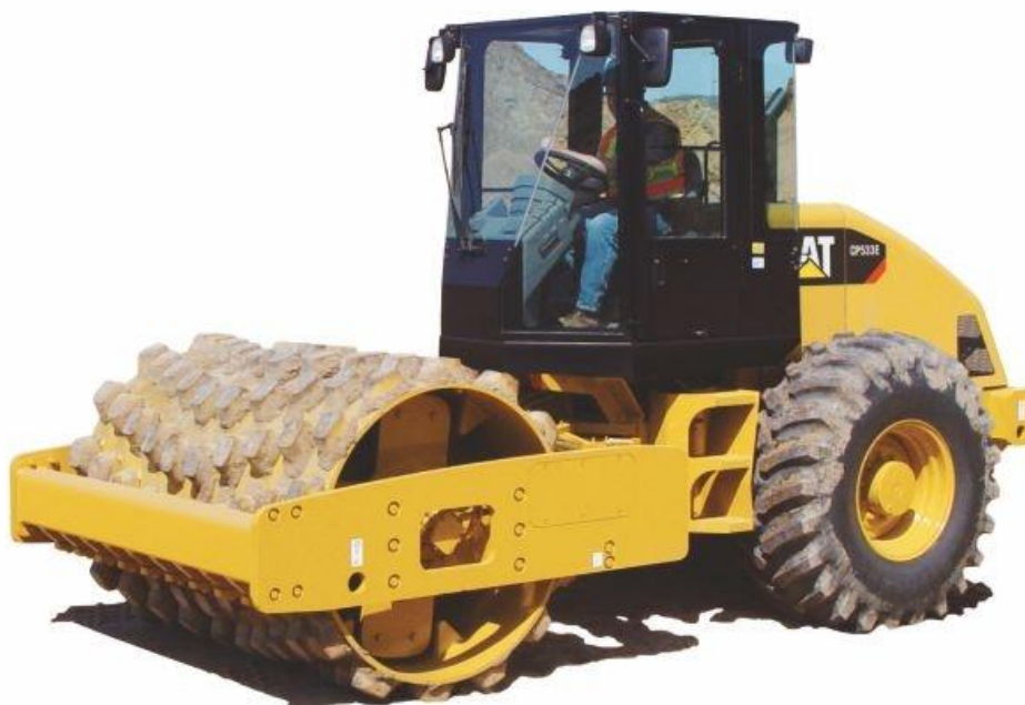
Foto 36 - Maquinário rolo vibrador
