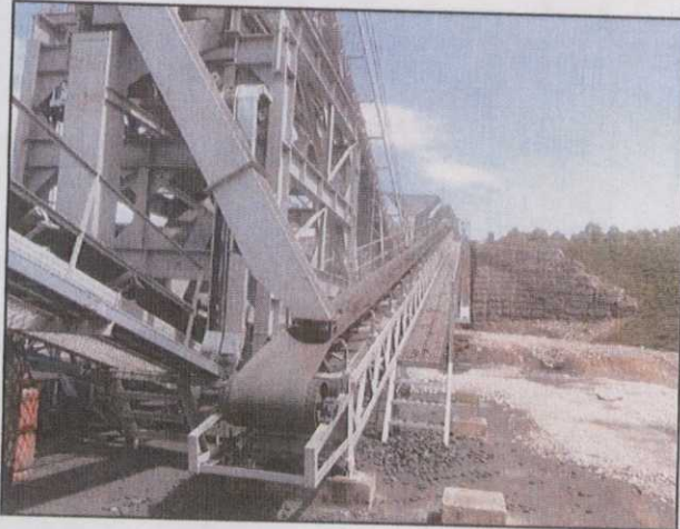
Foto da correia após separação dos finos, antes da alimentação do jigge:
