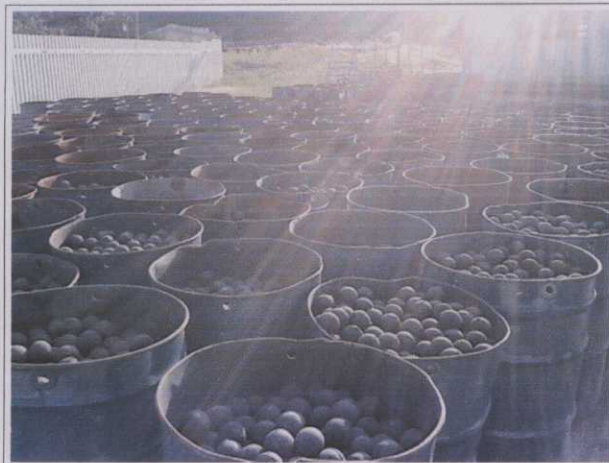
Figura 13. Armazenamento inadequado/indevido de resíduos sólidos – esferas metálicas para moinhos de carvão - em área externa ao Almoarifado.
