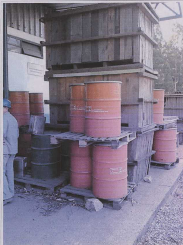
Figura 11 – Armazenamento inadequado de resíduos perigosos em pátio de manobras da Central.
