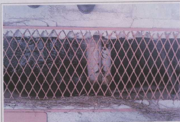
Figura 3A – Presença de poço de monitoramento no pátio do estacionamento. Solicita que seja tamponado e abandonado, já que não há garantia de sua integridade física e representatividade dos dados.
