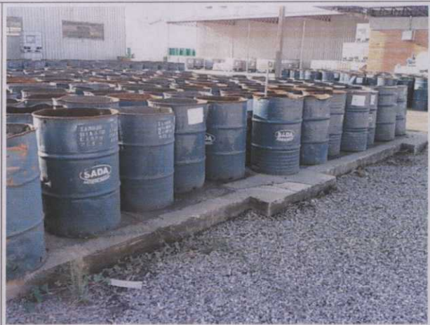
Figura 13. Armazenamento inadequado/indevido de resíduos sólidos – esferas metálicas para moinhos de carvão - em área externa ao Almoarifado.
