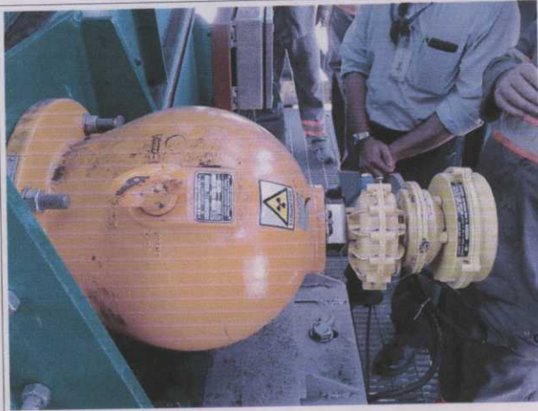
Figura 1C – Fonte Radioativa de Co-60 (100 mCi) utilizada no monitoramento do processo.
