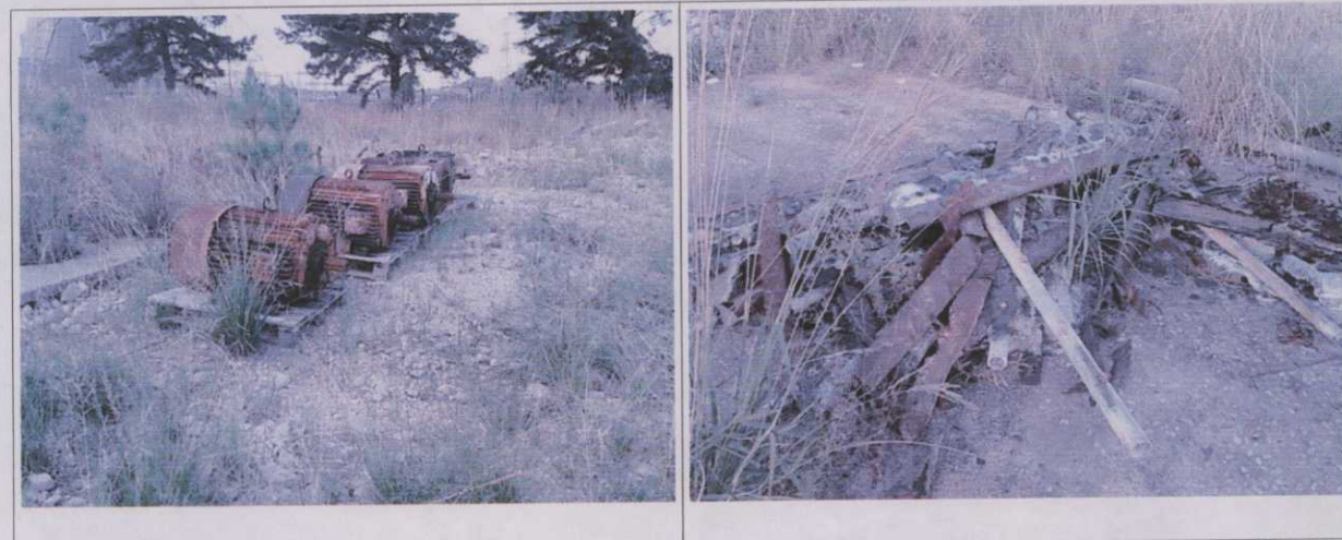
Figura 6A – Resíduo metálico gerado no acidente com a Torre de Refrigeração
