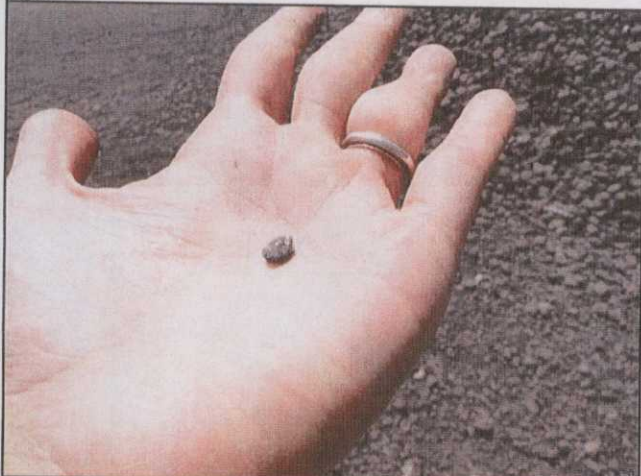
Amostras de pirita que pelo tamanho mostra a notória eficiência de separação do jigge:
