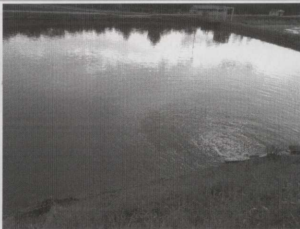
Figura 2 – Pluma de Óleo em efluente líquido da Lagoa de Sedimentação da UTPM
