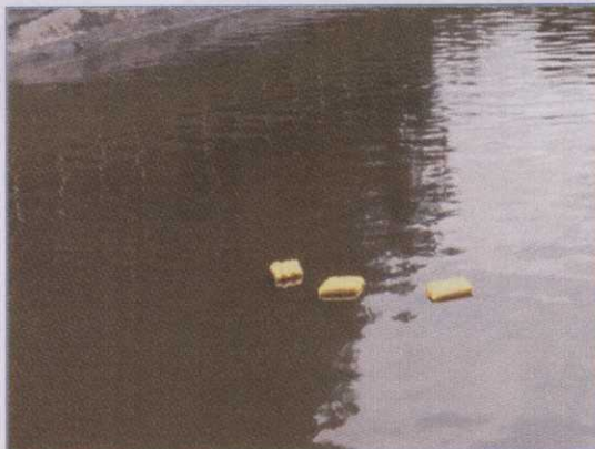
Figura 08. Travesseiros absorventes instalados na Bacia N° 4 como indicador de presença de óleo.
