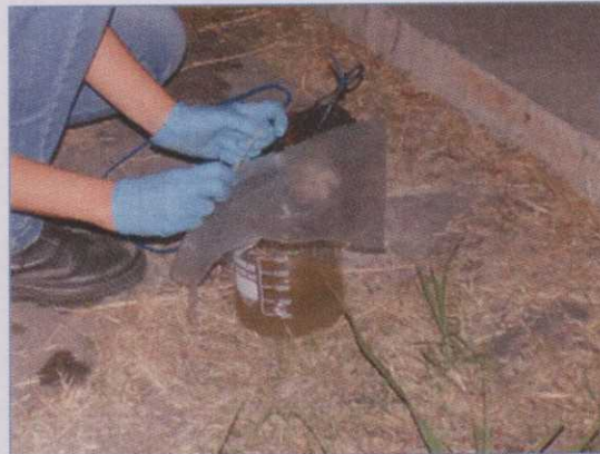
Figura 09. Preparo de frascos e coleta de amostras para análise de Óleos e Graxas.
