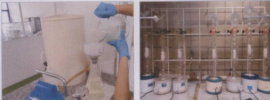
Figura 11. Filtragem das amostras e análise de Óleos e Graxas em Laboratório.
