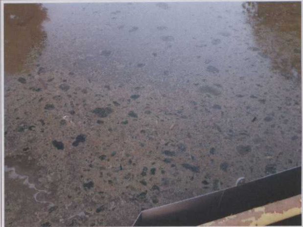
Figura 2 – Pluma de Óleo em efluente líquido da Lagoa de Sedimentação da UTPM
