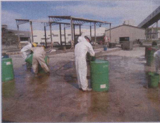
Figura 02. Limpeza dos tambores com resíduo oleoso.
