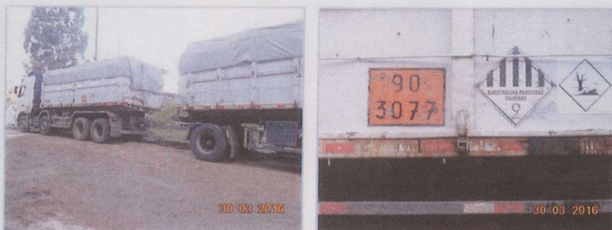
Figura 6. Visualização do veículo carregado e da identificação de risco.
