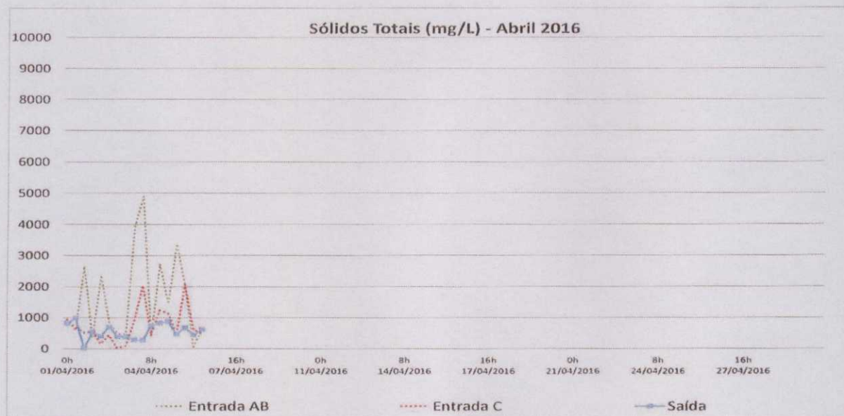
Figura 42. Análise de sólidos totais no efluente a cada 8 horas – Abril/2016.
