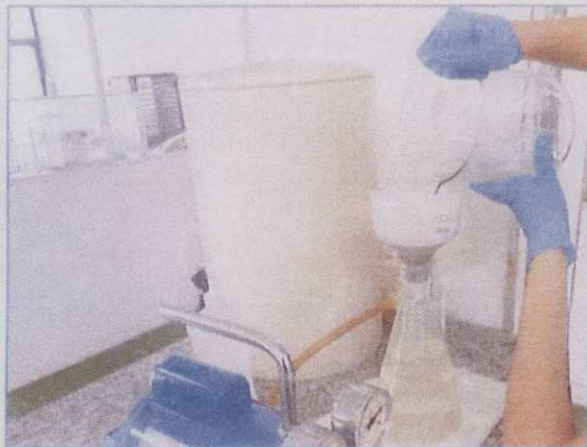
Figura 32. Filtragem das amostras e análise de Óleos e Graxas em Laboratório.
