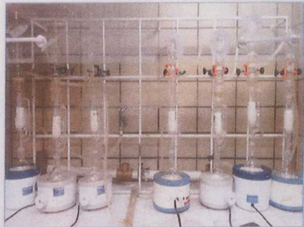
Figura 32. Filtragem das amostras e análise de Óleos e Graxas em Laboratório.
