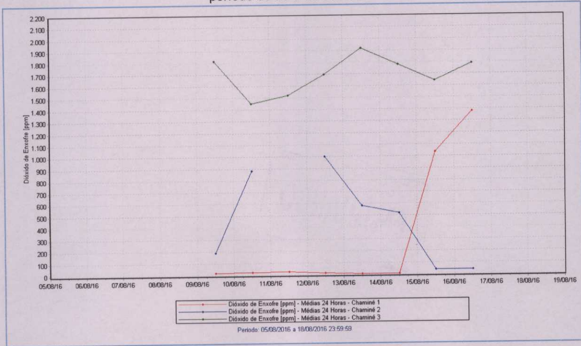
Figura 5. Médias 24 horas para o Dióxido de Enxofre ( \text{SO}_2 ) medido no Sistema de Monitoramento de Emissões Atmosféricas das Fases A e B no período de 05 a 18/08/2016.
