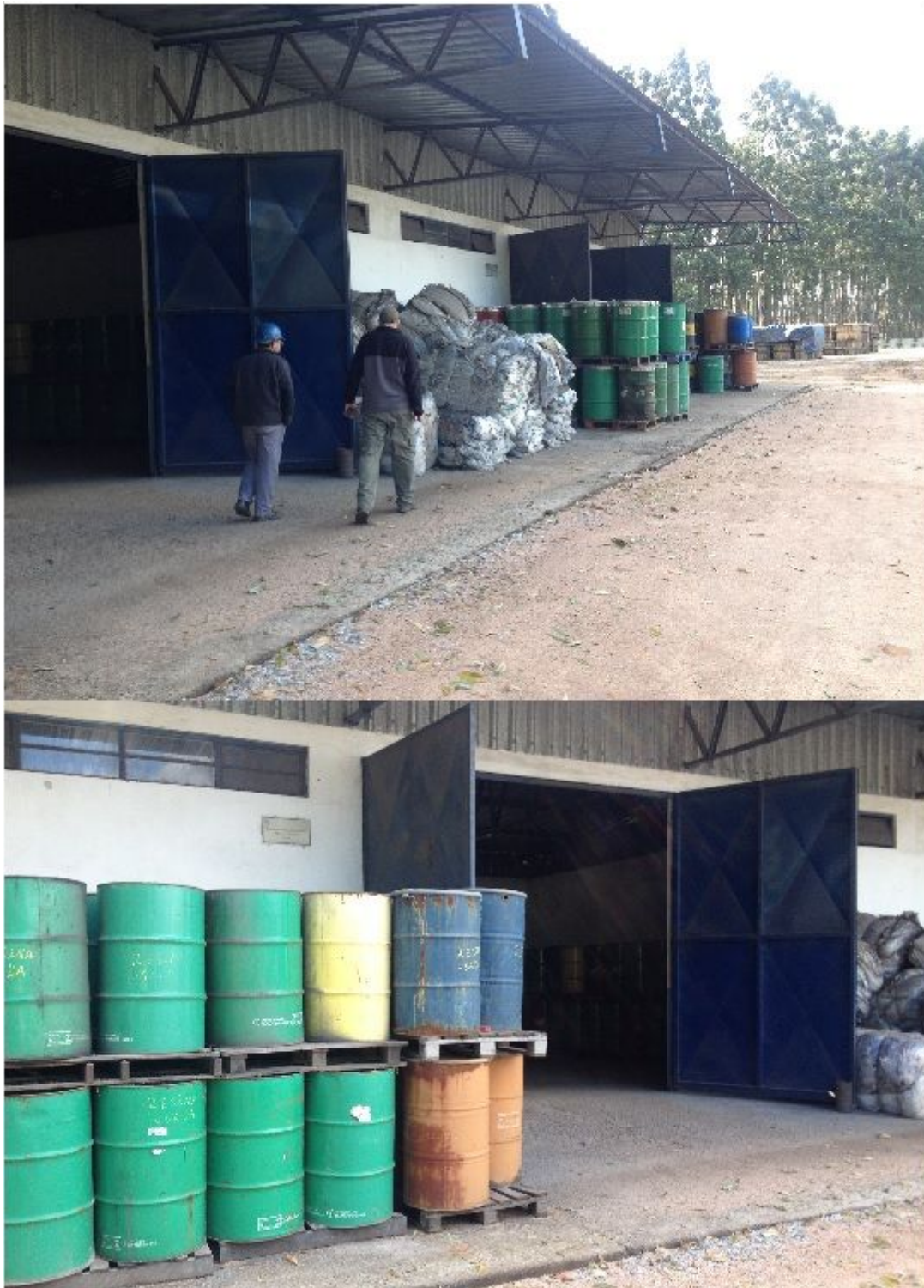
Figura 51: Tambores com resíduos classe I (resina usada) acondicionados fora da área da central destinada para resíduos perigosos
