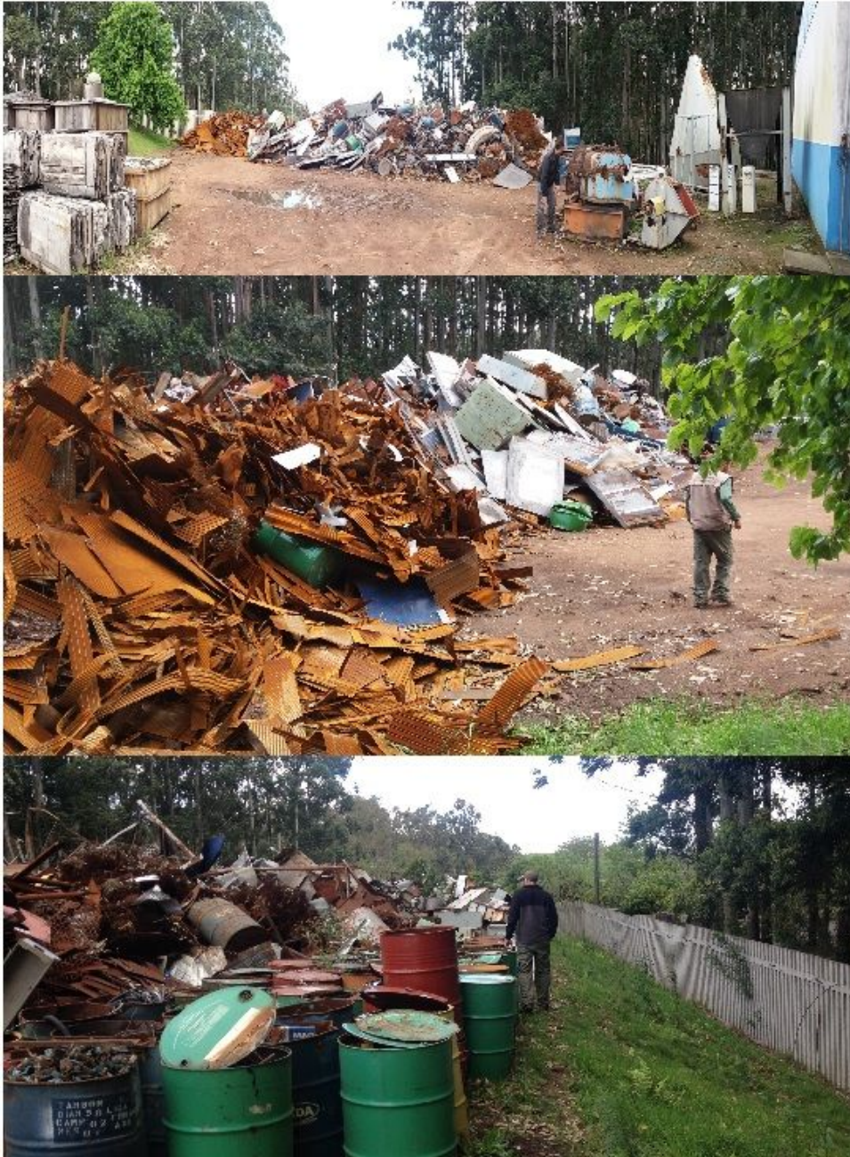
Figura 45 - Material ferroso acondicionado de forma inadequada à esquerda da central
