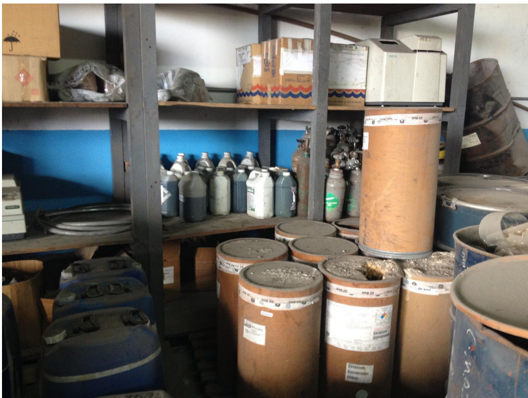
Figura 48: Ponto 2 da foto 46 – Garrafas com resíduo líquido não identificado encontrados em área da Central não destinada para acondicionamento de resíduos classe I
