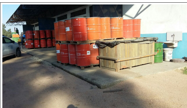
Foto 2. Tonéis com resíduos oleosos armazenados de forma inadequada na área externa do depósito.
