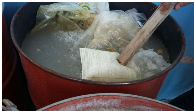
Foto 3. Composto solidificado composto por água e óleo emulsionado, aguardando destinação.
