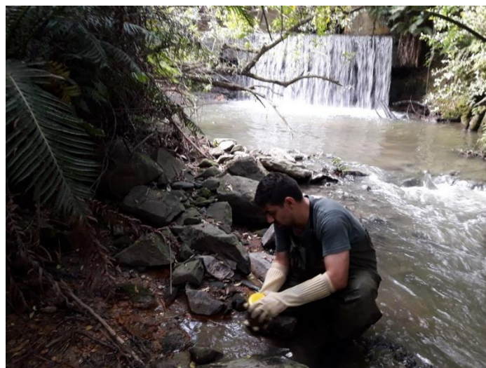
Fotografia 3 - A queda de água ao fundo, é a saída do efluente da estação de tratamento. O pesquisador observa e se prepara para amostrar o material solicitado pelo IBAMA de particulados sedimentados a partir do efluente.
