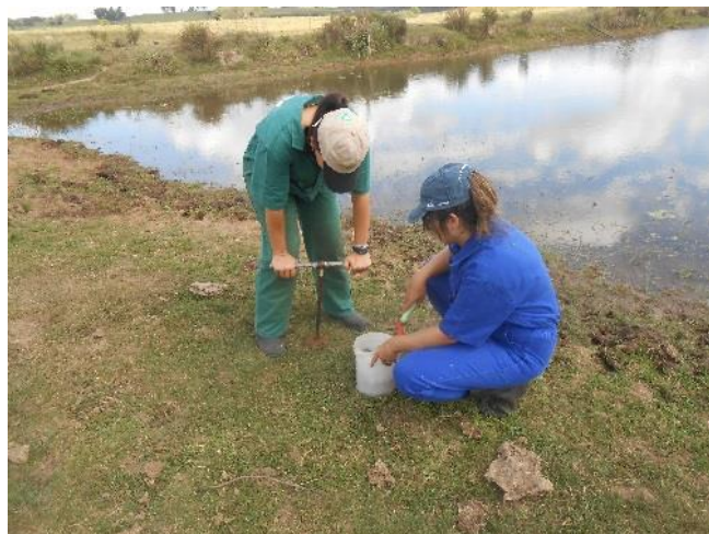
Figura 8.2: Amostragem de solo
