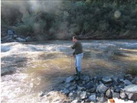
Figura 9 - Coleta de amostra para análise de sólidos em suspensão com o amostrador DH-48. Fonte: Ecosystems, 2017.
