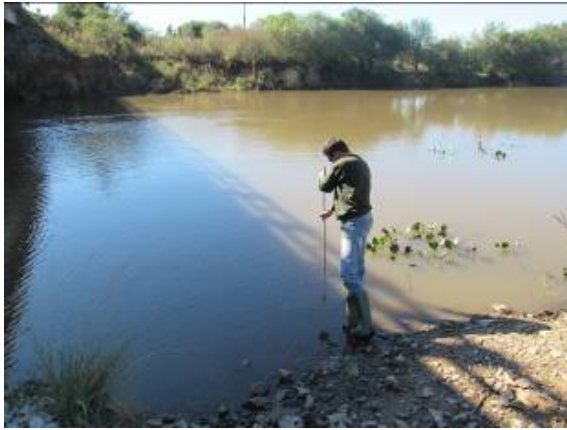
Figura 5 – Coleta de amostra para análise de sólidos em suspensão com o amostrador DH-48. Fonte: Ecosystems, 2017.
