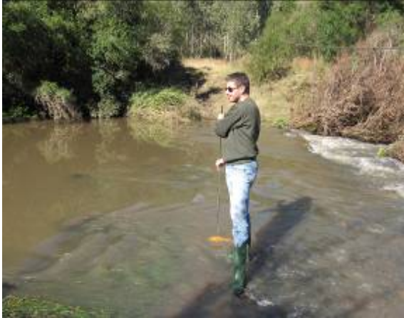
Figura 1 - Coleta de amostra para análise de sólidos em suspensão com o amostrador DH-48. Fonte: Ecossis, 2017.
