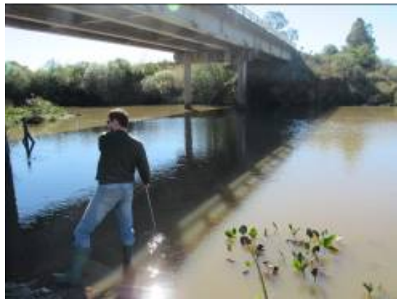
Figura 7 - Coleta de amostra para análise de sólidos em suspensão com o amostrador DH-48. Fonte: Ecosystems, 2017.
