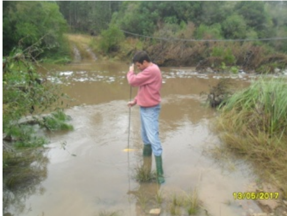
Figura 6 - Coleta de amostra para análise de sólidos em suspensão com o amostrador DH-48. Fonte: Ecosystem, 2017.
