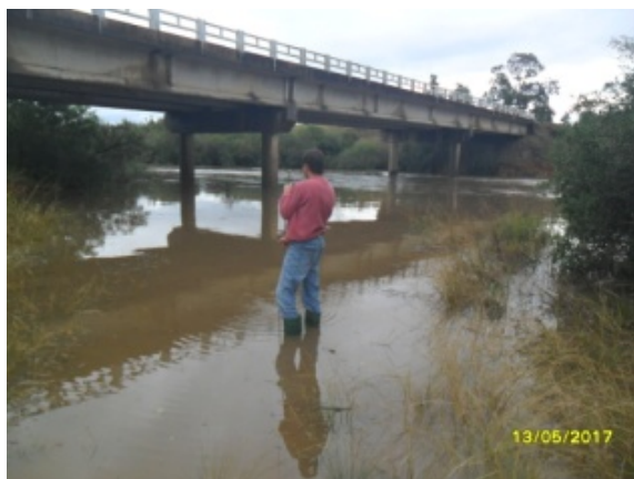
Figura 12 - Coleta de amostra para análise de sólidos em suspensão com o amostrador DH-48. Fonte: Ecosystem, 2017.
