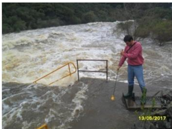
Figura 14 - Coleta de amostra para análise de sólidos em suspensão com o amostrador DH-48. Fonte: Ecosystems, 2017.
