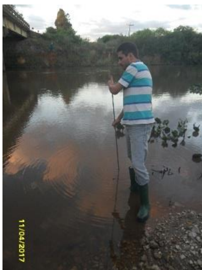
Figura 12 - Coleta de amostra para análise de sólidos em suspensão com o amostrador DH-48. Fonte: Ecosystem, 2017.
