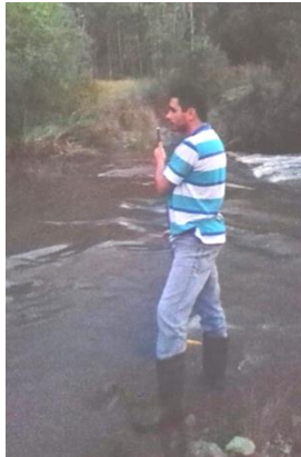
Figura 6 - Coleta de amostra para análise de sólidos em suspensão com o amostrador DH-48. Fonte: Ecossis, 2017.
