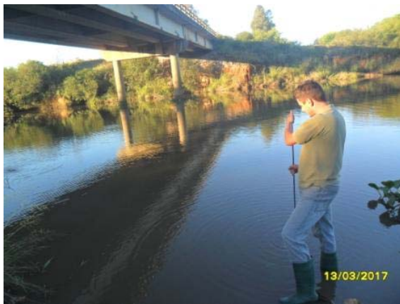
Figura 7 - Coleta de sólidos em suspensão com o amostrador DH-48. Fonte: Ecosystems, 2017.
