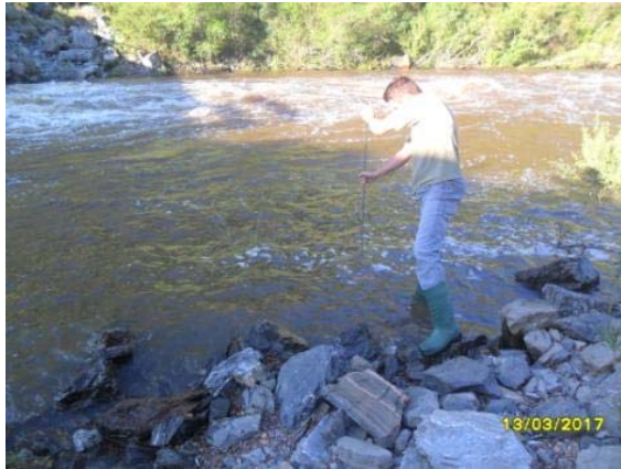
Figura 9 - Coleta de sólidos em suspensão com o amostrador DH-48. Fonte: Ecosystem, 2017.
