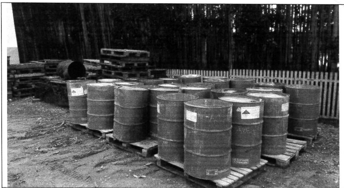
F6. Armazenamento indevido de resíduos oleosos sobre piso não impermeabilizado, desprovido de cobertura e sistema de drenagem dedicado.
