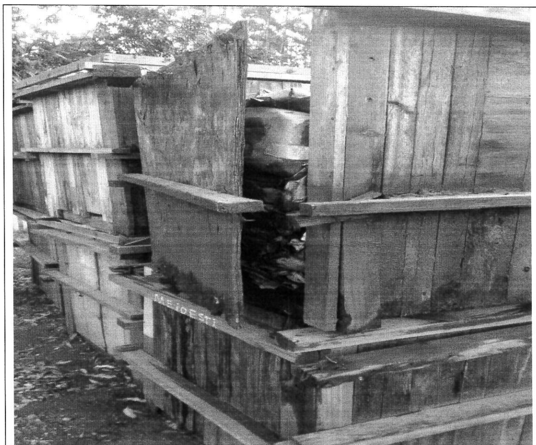
F7. Resíduos sólidos contaminados com óleo armazenados sobre piso não impermeabilizado, desprovido de cobertura e sistema de drenagem dedicado
