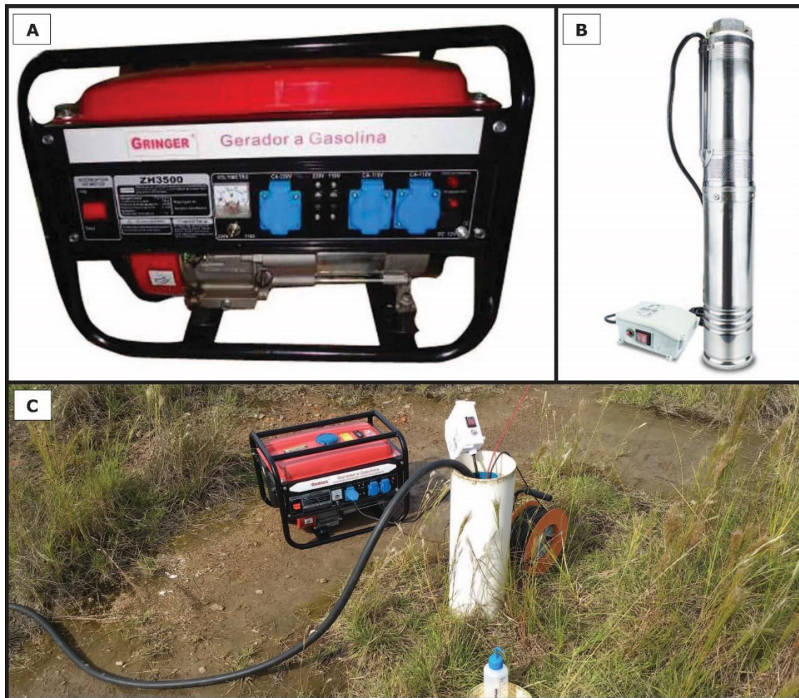
Figura 4.2.3 - (A) Gerador Gringer ZH3500 para ligar a bomba submersível; (B) Bomba de água submersível 1/2HP e 1,5" Tander profissional; (C) Amostragem poço PM-10 apresentando o sistema utilizado para o esgotamento de poços com maior volume de água devido o maior diâmetro do poço para o monitoramento de água subterrânea de Candiota.
