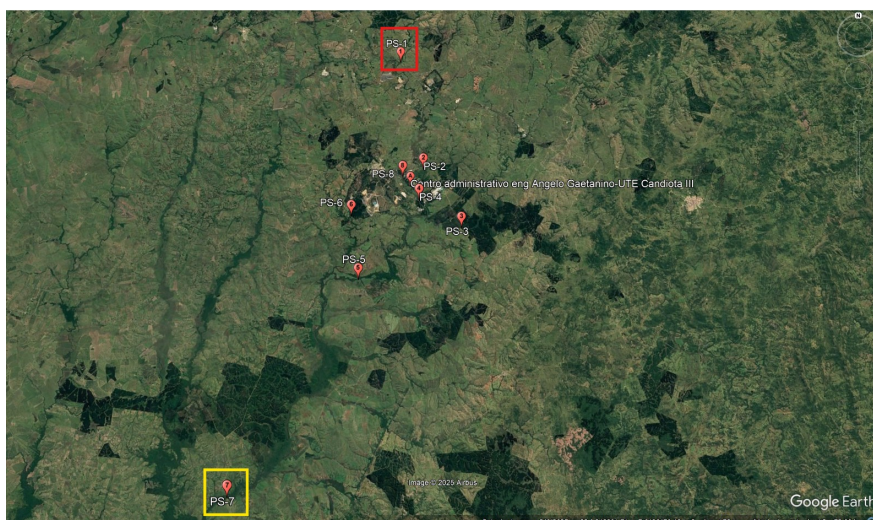
Figura 8: Malha amostral do monitoramento da qualidade da água superficial e sedimentos da UTE Candiota. A estação amostral 1 (quadrado vermelho) é a estação de referência por estar a montante da UTE, enquanto a estação amostral 7 (quadrado amarelo) é a referência a jusante da bacia, após a contribuição de várias atividades antrópicas. A estação amostral 8 está localizada após o lançamento do efluente tratado na UTE Candiota.
