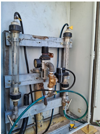
Figura 16: Sistema utilizado para controle de vazão e tempo de injeção do gás no cultivo da microalga Spirulina .
