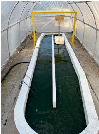
Figura 10: Instalação do sistema de agitação por pás rotativas no biorreator de inóculo.
