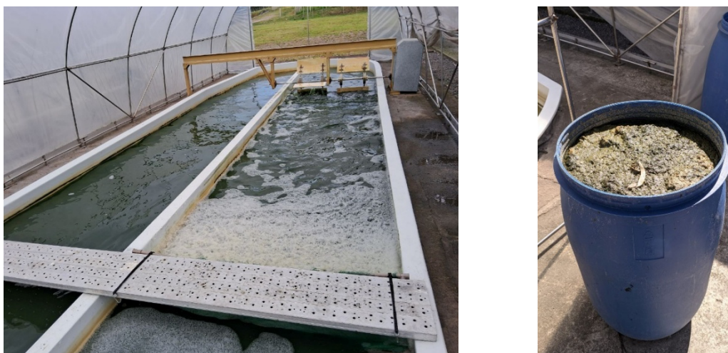
Figura 1: Biorreator 2 com o inóculo de microalga com formação de espumas e biomassa morta retirada do sistema.
