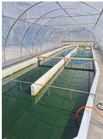
Figura 4: Biorreator 1 com o inóculo de Spirulina .
