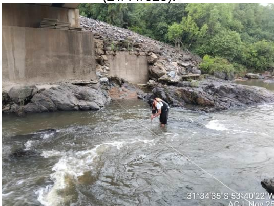
Figura 37 - Medição de descarga líquida, ACJ (21/11/2025).
