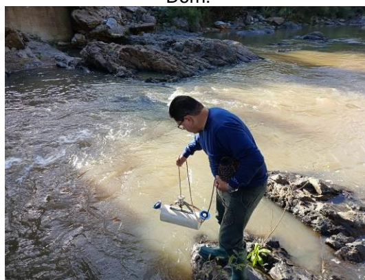
Figura 8 – Coleta de amostra com garrafa de Van Dorn.
