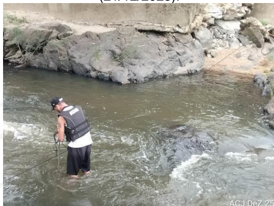
Figura 39 - Medição de descarga líquida, ACJ (21/12/2025).
