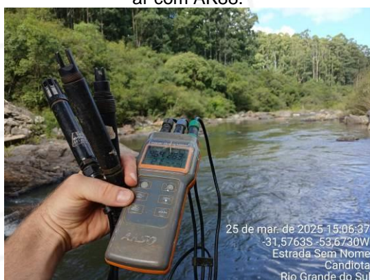
Figura 7 – Aferição do parâmetro de temperatura do ar com AK88.
