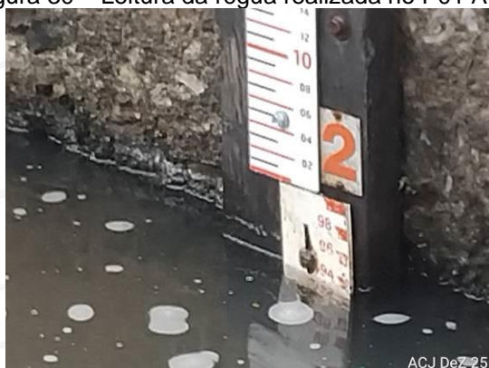
Figura 30 – Leitura da régua realizada no P01 ACJ.
