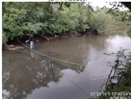
Figura 38 - Medição de descarga líquida, ACM (21/11/2025).
