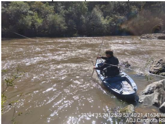
Figura 35 - Medição de descarga líquida, estação ACJ (08/10/2025).
