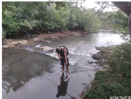
Figura 40 - Medição de descarga líquida, ACM (21/12/2025).
