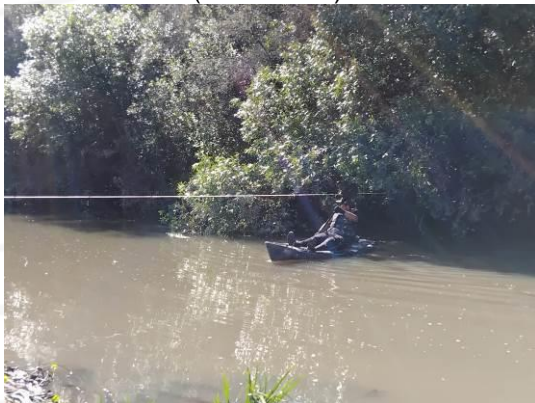
Figura 33 - Medição de descarga líquida (30/08/2025).
