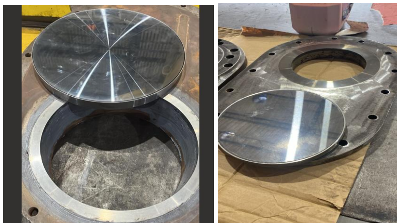
Figura 21- válvulas dos propulsores de cinza com sedes revestidas
