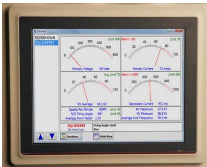
Figura 7 – interface de operação dos novos controladores de tensão.
