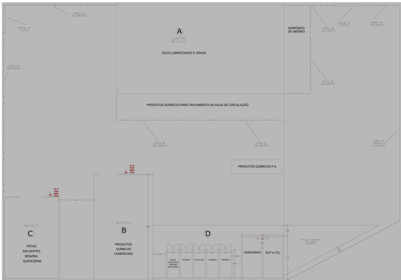
Figura 4 - Disposição da armazenagem de produtos químicos no almoxarifado (Fonte: PPCI - Planta baixa do local de armazenamento dos produtos químicos)
