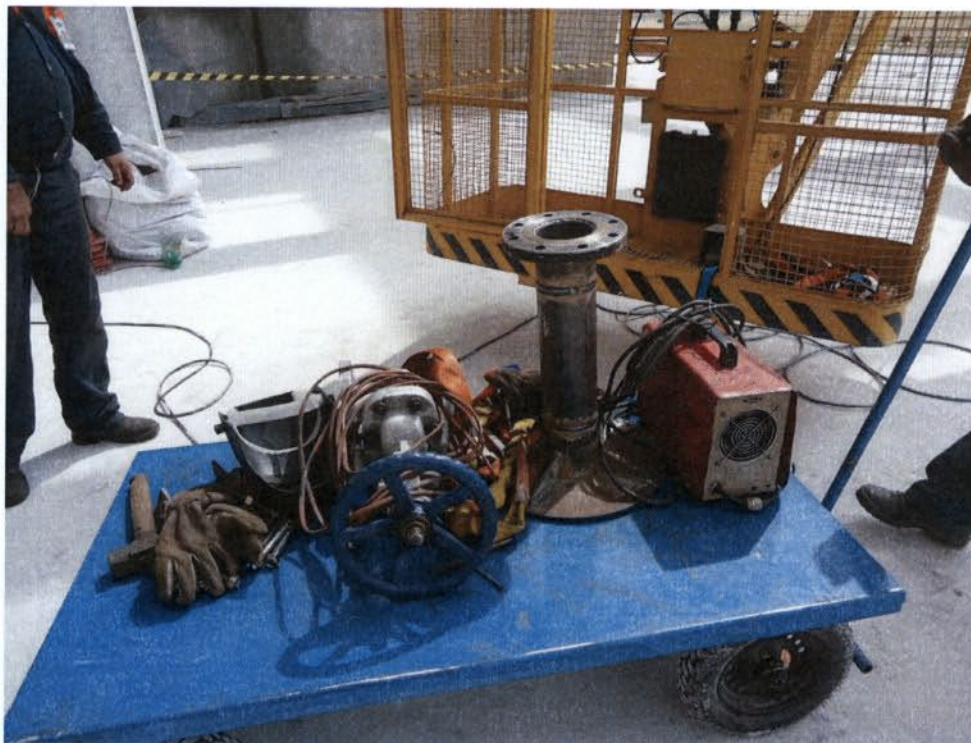
Figura 24: Material utilizado para instalação do ponto e Tie-in montado
