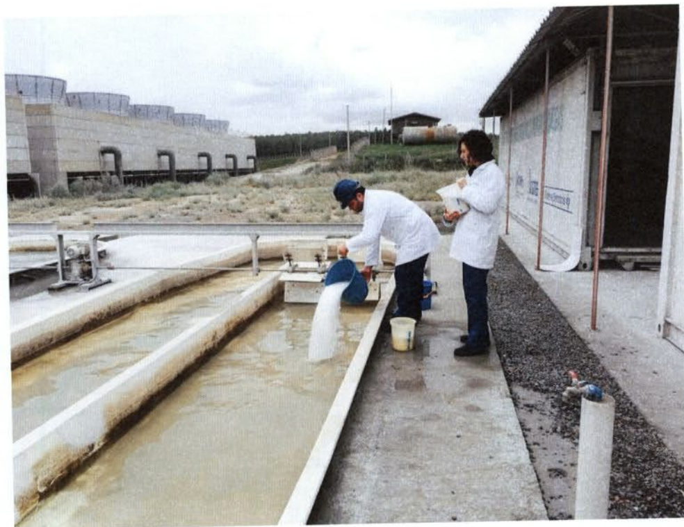
Figura 66: Preparo do meio de cultivo e inoculação da microalga nos fotobiorreatores da planta piloto
