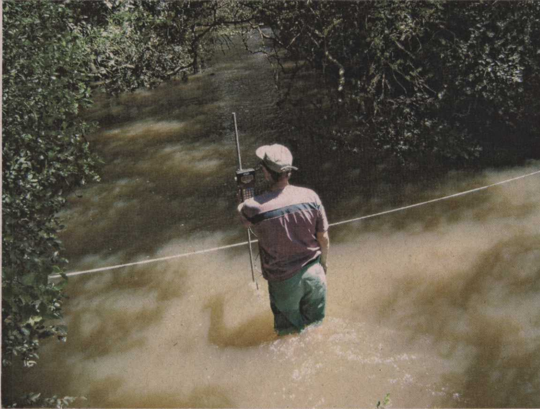
3. Medição de vazão no ponto Arroio Candiota Montante - ACM.
