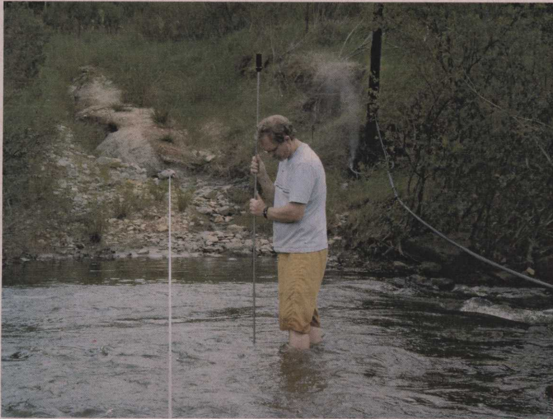
5. Coleta de sólidos em suspensão no ponto Sanga Funda Montante - SFM.
