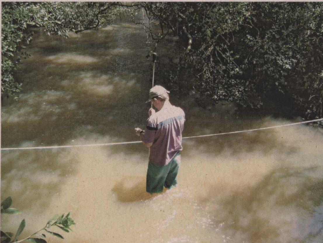
4. Coleta de sólidos em suspensão no ponto Arroio Candiota Montante.
