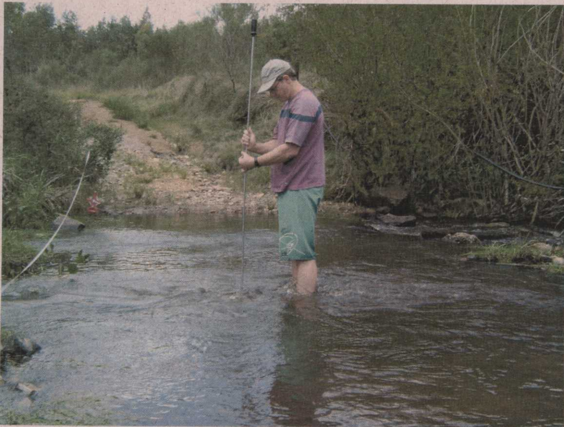
6. Coleta de sólidos em suspensão no ponto Sanga Funda Montante - SFM.
