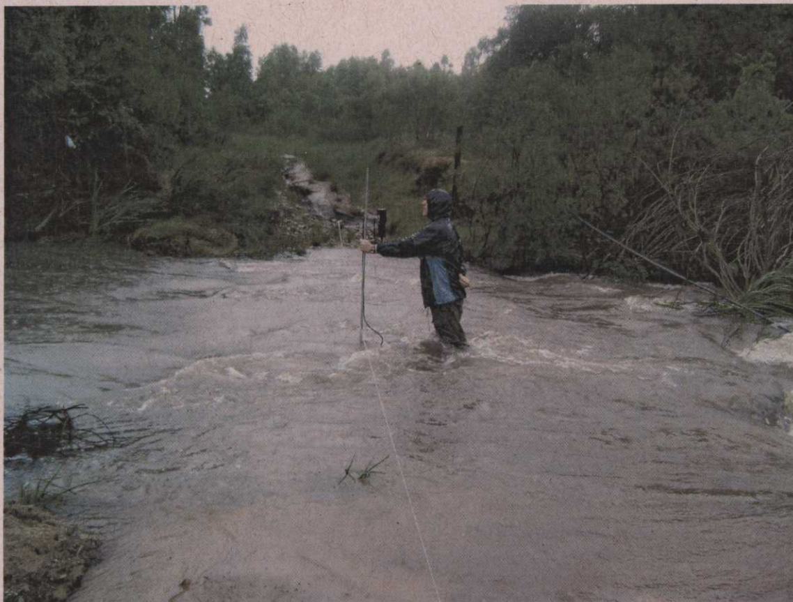
5. Medição de descarga líquida no ponto Sanga Funda Montante – SFM.
