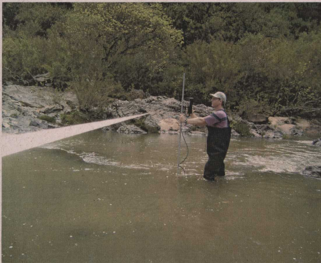
1. Medição de descarga líquida no ponto Arroio Candiota Jusante - ACJ.
