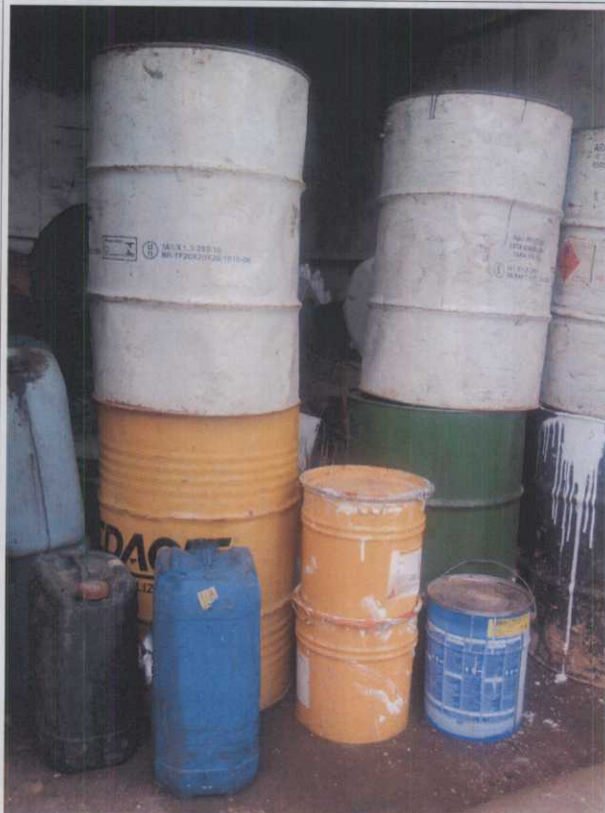
A.72. Resíduos Sólidos perigosos (com traços de substâncias inflamáveis) armazenados inadequadamente.
