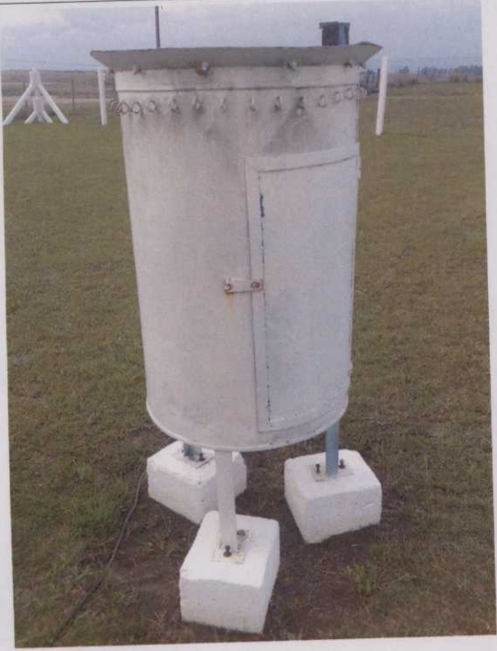
A.94. Coletor de água de chuva.
