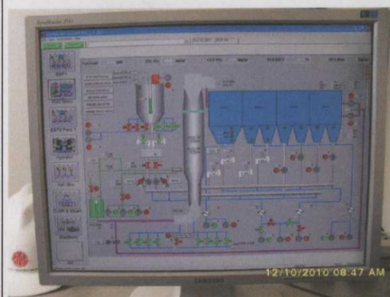
Figura 5 – Tela de Comando Principal do FGD – 350 MW
