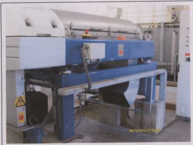
Foto 68 Centrifuga de separação da lama do sistema de tratamento d'água
