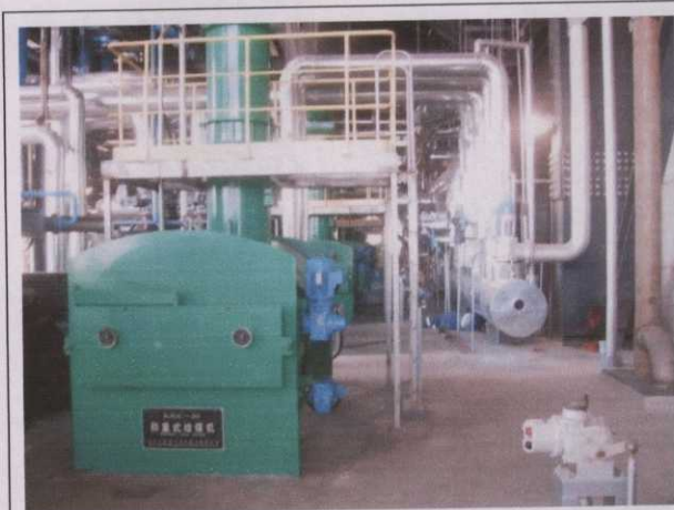
Foto 34 Mesa Dosadora do Carvão montada e em operação
