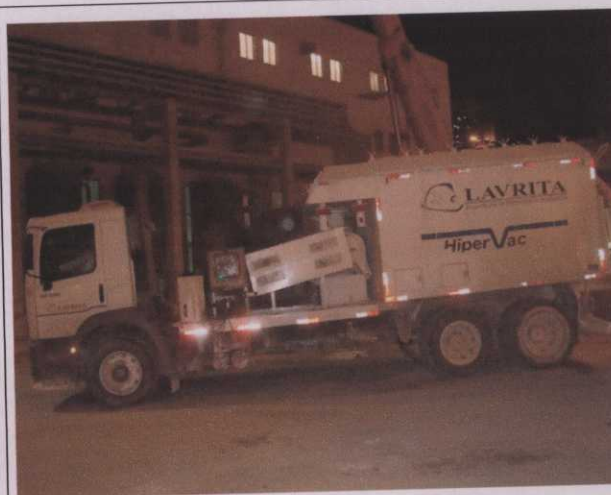
Figura 7 - Posicionamento do caminhão auto-vácuo durante trabalhos noturnos
