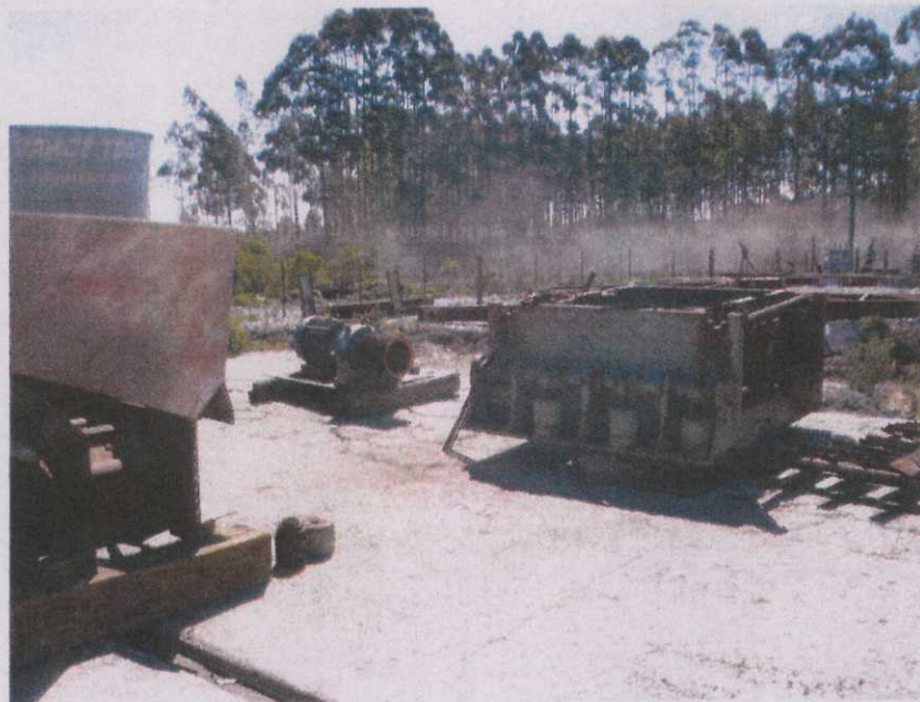
Foto 7: Conjunto Motor/Redutor para utilização no Britador, Carcaça do Britador (direita) e Alimentador de Esteira (esquerda).
