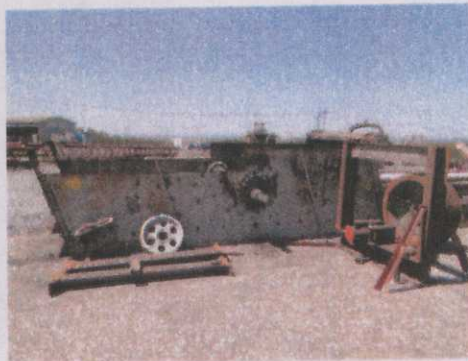
Foto 2: Equipamentos mecânicos em fase de recuperação, componentes da peneira classificadora.
