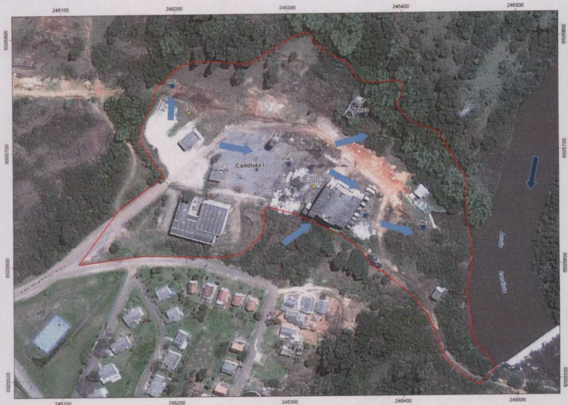
Figura 25. Mapa mostrando as direções de fluxo subterrâneo na área de Candiota I.
