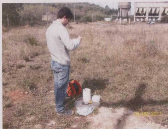
Figura 17. Execução do ensaio Slug no poço PMC4.
