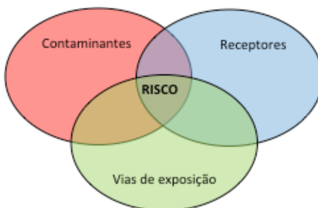
Figura 3.4-2: Interrelação de elementos para caracterizar risco potencial
